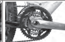
Upshifting at the front derailleur.
