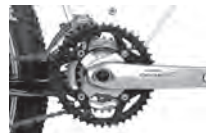
Downshifting at the front derailleur.
