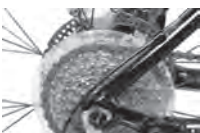
Downshifting at the rear derailleur.
